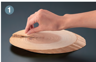
1 木材の割れ、節に同じ材質の木粉を充填する。
